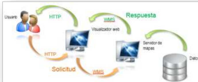
Figura 1. Esquema de la plataforma para la publicación y consulta de mapas vía web
