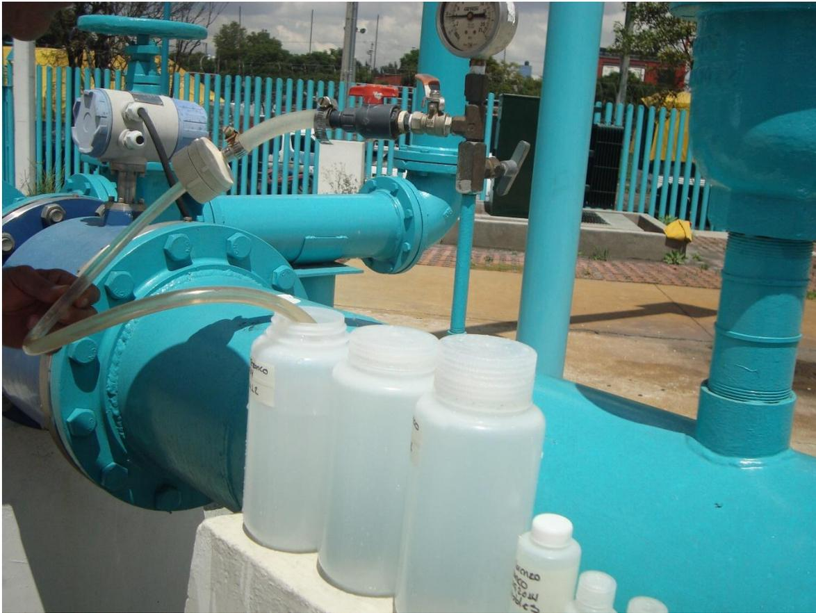
Figura 8 Material utilizado en la colecta y filtrado de muestras para medición de parámetros fisicoquímicos de laboratorio.
