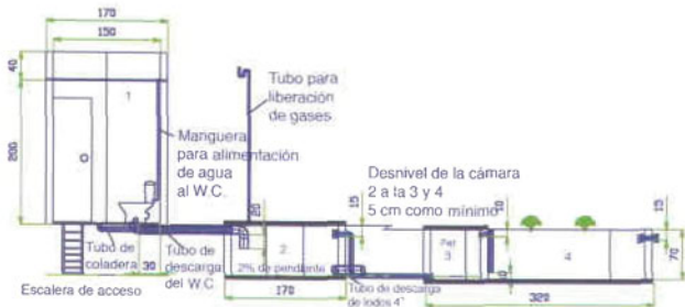
Figura 2. Sanitario ecológico con la caseta separada (en línea)
