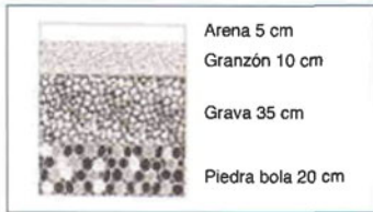
Figura 52. Colocación del material graduado.
