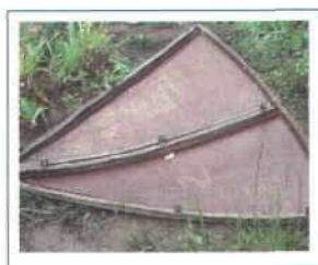
Figura 30. Los gajos se atornillan en pares.
