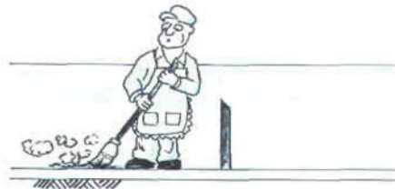
Figura 24. El canal debe limpiarse para eliminar azolves.
