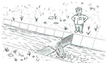
Figura 1. Los vertedores son probablemente las estructuras de aforo más comunes en los canales.
