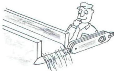
Figura 4. La cresta de un vertedor debe ser fina, pero no tan afilada como una navaja.
