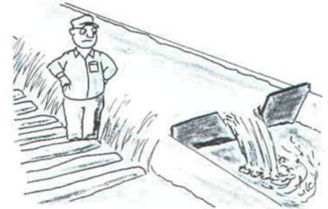
Figura 25. La principal desventaja del vertedor es el remanso que causa en la red de canales.
