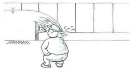
Figura 2. El flujo debe tener un espacio aireado por debajo y lateralmente.
