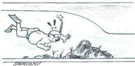
Figura 3. Cualquier obstáculo regular al flujo puede servir como aforador, siempre y cuando se establezca una relación entre gasto y carga (con una piedra no sería posible).
