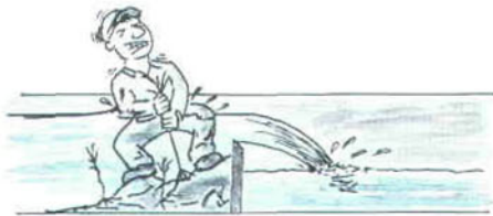
Figura 6. Los vertedores no deben alojar sedimentos aguas arriba.
