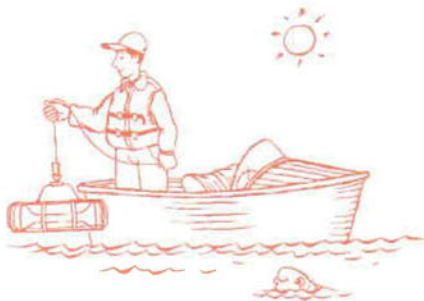
Figura 2.5 Uso de la botella Van Dorn para obtener muestras de agua superficiales y de fondo en cuerpos de agua.
