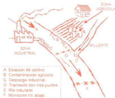
Figura 3.2 Establecimiento de estaciones en un río grande, tomando en cuenta las fuentes de contaminación presentes.
