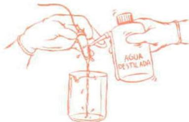
a) Preparación. El sistema seleccionado para determinación del pH, se debe preparar interconectando el electrodo al potenciómetro, por medio del conector apropiado ya sea coaxial BNC (Bayoneta Neill-Concelman, conector coaxial tipo bayoneta), US standard, o emplear el adaptador necesario. Energizar el sistema y conforme al manual del fabricante proceder a calibrar.
