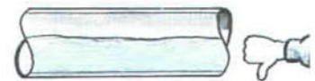
Figura 4.4 Es importante que la tubería trabaje a tubo lleno y no como canal.
