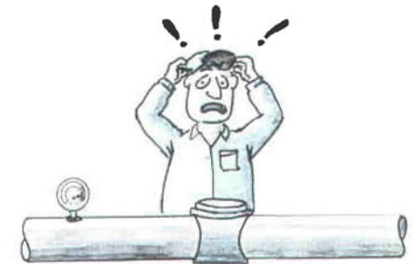
Figura 4.3 Las subpresiones y sobrepresiones ocasionan daños dentro de los medidores.
