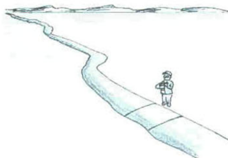
Figura 4.1 Los tramos de un cauce con menor número de perturbaciones son los que se utilizan como tramos de aforo.
