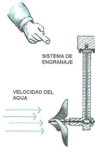
Figura 6.2 El funcionamiento de este tipo de registrador es básicamente la relación de la velocidad del agua con un sistema de relojería con el que cuenta el aparato.
