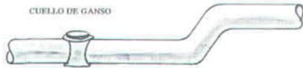
Figura 3.6 Se puede construir un cuello de ganso en las descargas libres con el objeto de que el medidor funcione a tubo lleno.
