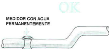
Figura 4.5 El cuello de ganso presenta una alternativa para que el tubo trabaje lleno.
