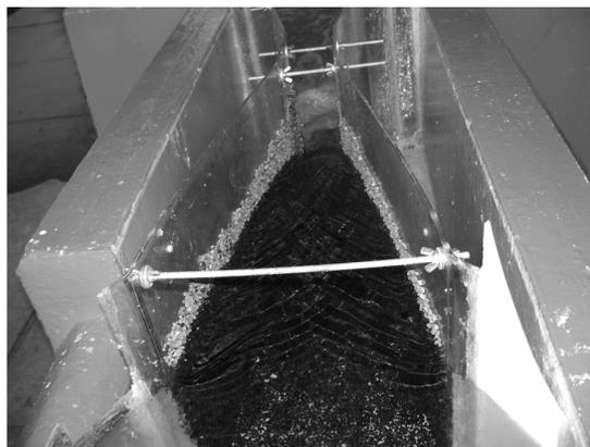
Figura 14. Aforador recubierto con arena de 5 mm.
