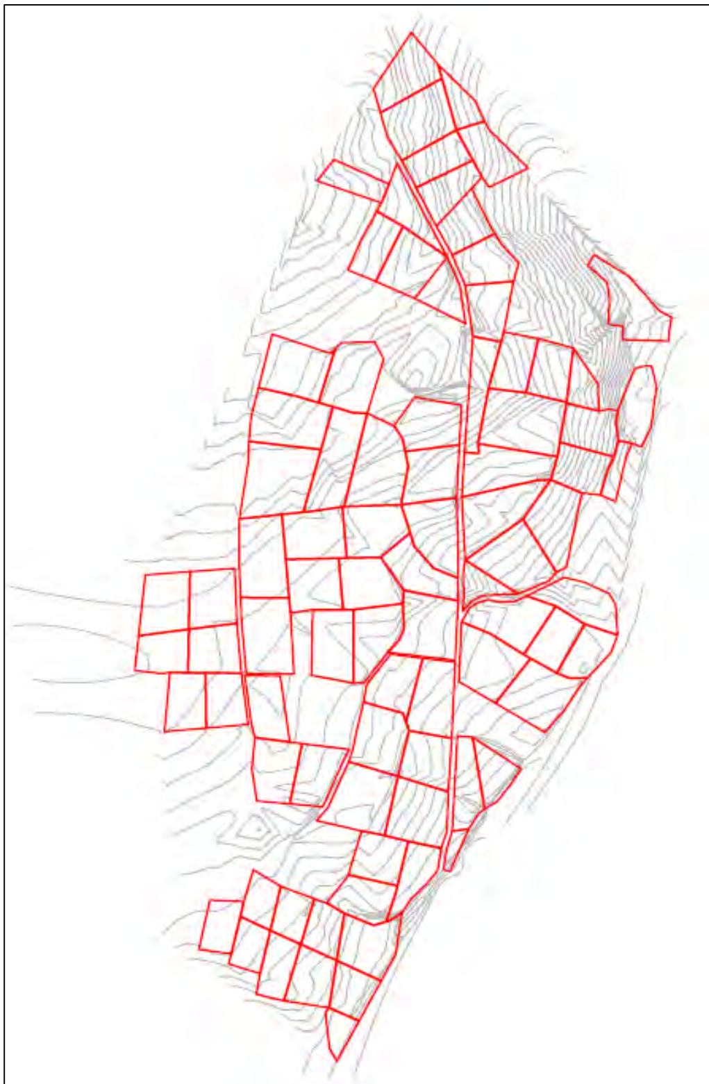
Figura 113. Bloques de riego y topografía
