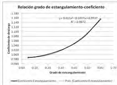
Figura 3. Coeficiente C_d en relación al grado de estrangulamiento m .
