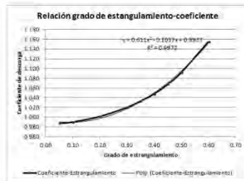
Ilustración 3. Coeficiente C_d en relación al grado de estrangulamiento m .
