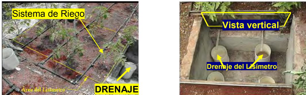
Figura 7.9 Esquema de un lisímetro de balance en un invernadero.
