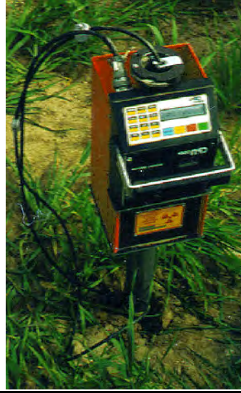
Figura 4.6 Aspersor de neutrones en campo.
