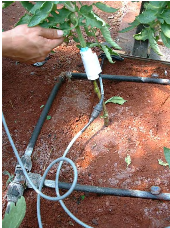
Figura 7.17 Sensor de flujo de savia para determinar el momento del riego.
