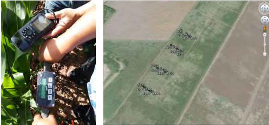
Figura 8.7 Monitoreo de la humedad del suelo con TDR y uso de sistemas de información geográfica como herramienta de apoyo para seguimiento del riego a nivel parcelario
