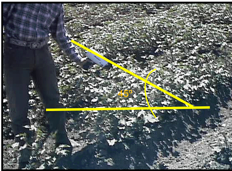
Figura 4.3 Pistola de rayos infrarrojos operando en campo para medir la temperatura del follaje.
