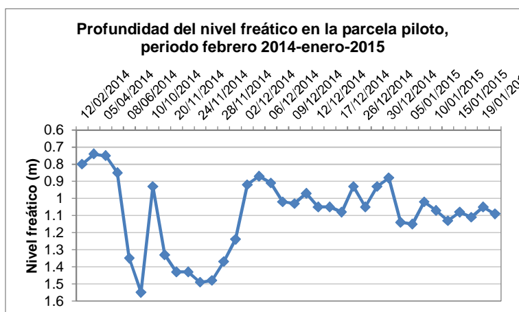
Ilustración 74. Variación del nivel freático en el cárcamo de bombeo durante 2104
