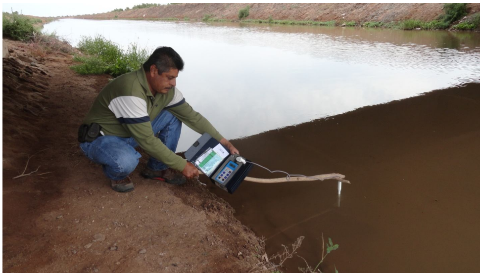
Ilustración 78. Medición in-situ de la conductividad eléctrica del agua en el dren T-O
