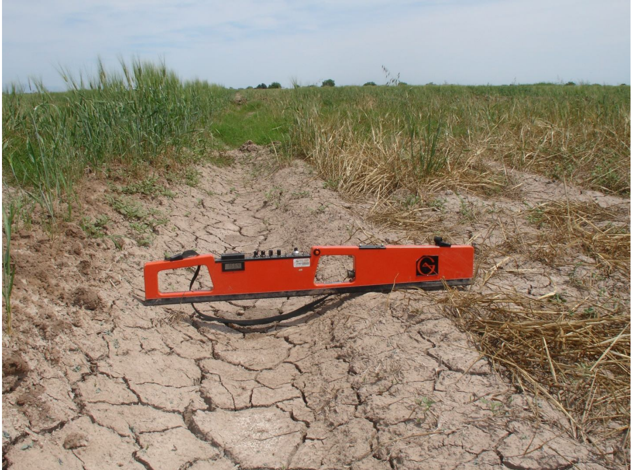
Ilustración 6. Medición de la salinidad en el estrato 0-150 cm de profundidad con el sensor en posición vertical, en marzo de 2014
