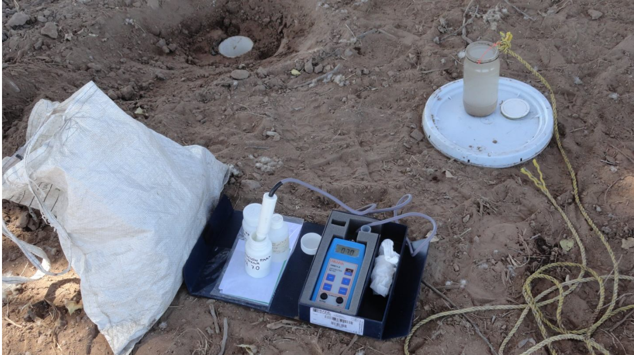
Ilustración 9. Monitoreo mensual de la salinidad del agua de los pozos de observación del manto freático superficial
