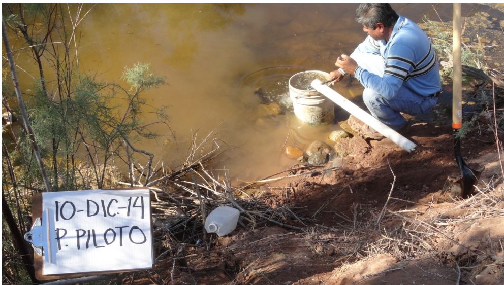
Ilustración 76. Aforo en la descarga de la línea de conducción, del agua bombeada por el molino de viento
