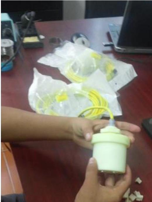
Sensor en cubierta de Nylacero
