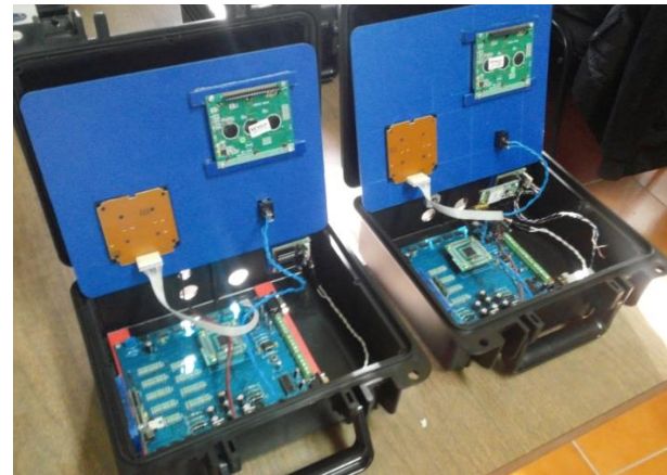
Parte interna del Hidrotermo-pluviómetro
