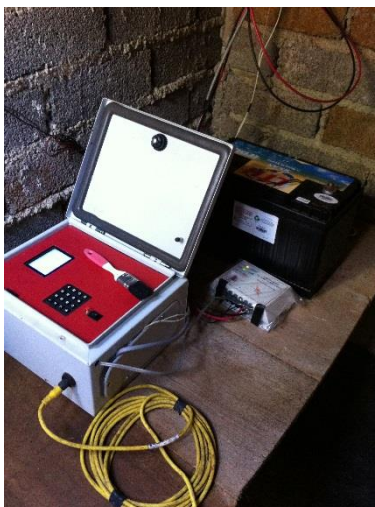
Ilustración I.66. Equipo medidor con sensor ultrasónico después del mantenimiento
