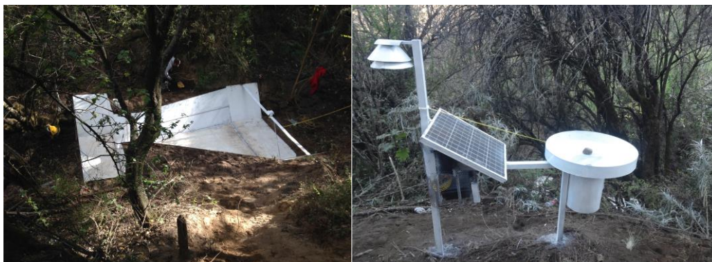
Ilustración I.58. Aforador y Estación instalados en el sitio de estudio.
