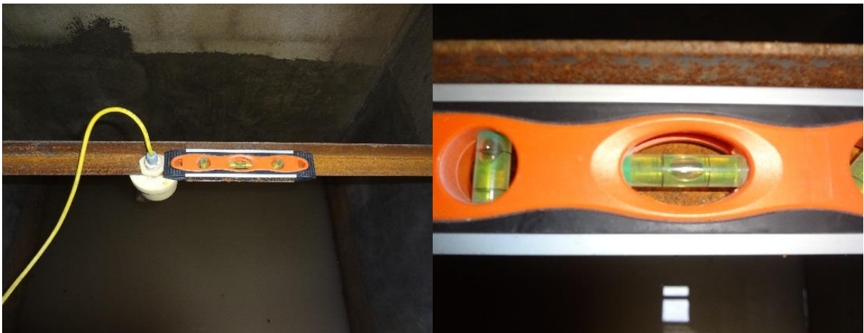
Ilustración I.72. Nivelación y reacomodo del sensor ultrasónico de la microcuenca Ichupio.
