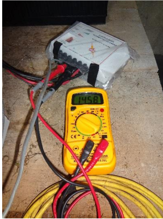
Ilustración I.63. Revisión del controlador de carga en la microcuenca Malacate.
