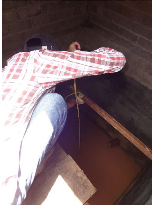
Ilustración I.64. Revisión del sensor ultrasónico en la microcuenca Malacate.
