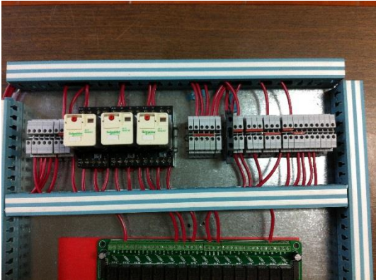
Ilustración II.8. Diseño del circuito de control de paneles y ensamblaje de éstos.
