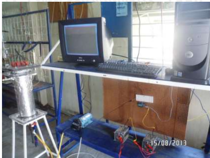
Figura 3.3. Sistema de monitoreo de las tres CCM's en tiempo real
