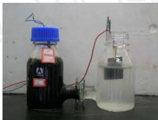
Figura 2.2. Celda de combustible microbiana de dos cámaras
