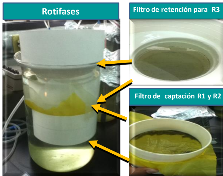
Figura 21. Diseño del Rotifases para aislamiento de hembras en fase R3 del rotífero B. plicatilis
