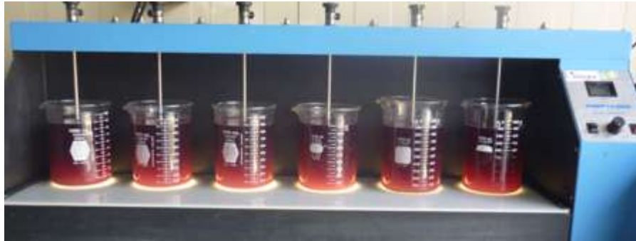
Figura 4.8 Inicio Prueba Fenton con efluente general de la industria Gütermann
