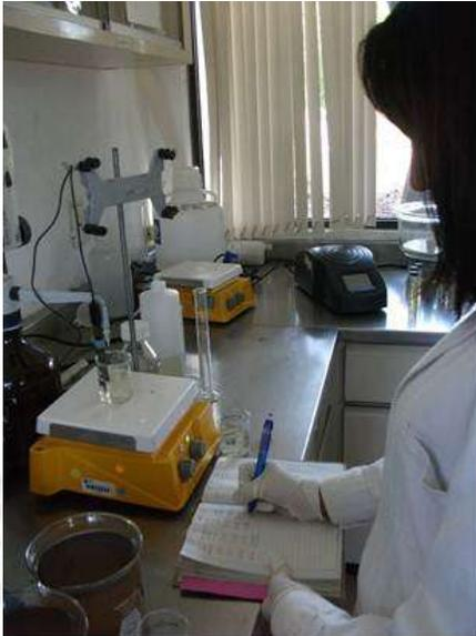
Foto 4.16 Determinación de dureza
