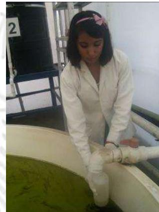
Foto 4.10 Toma de muestra salida del filtro
