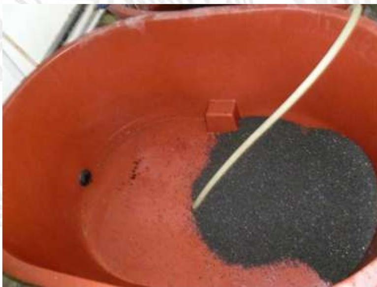
Foto 4.8 Lavado de material filtrante
