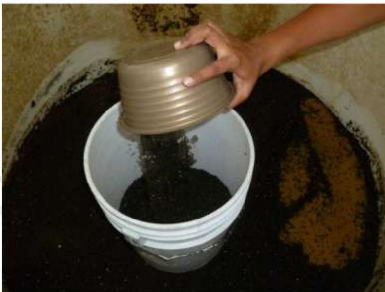
Foto 4.7 Retiro de la primera capa de material filtrante
