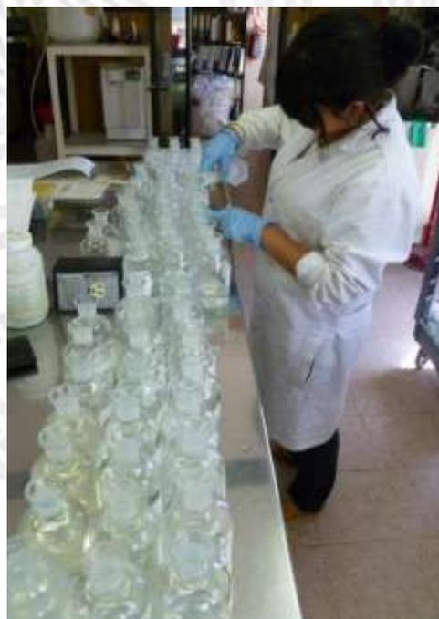
Foto 4.21 Determinación de DBO
