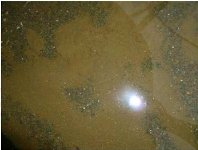
Foto 4.5 Acumulación de sólidos sobre el lecho de filtración
