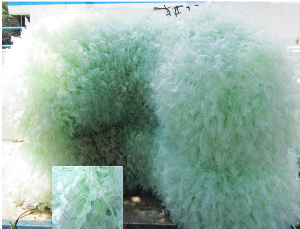
**Figura 2.4. Fotografía de la cinta y el empaque utilizado en los reactores.**
