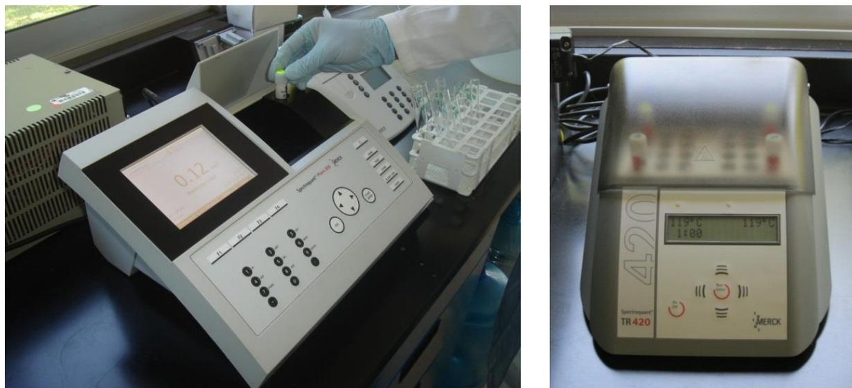
**Figura 5** Espectrofotómetro Merck y termorreactor para digestión de muestras
