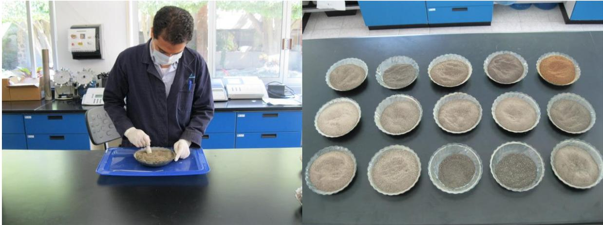
**Figura 7** Muestras de sedimento secas y disgregadas
