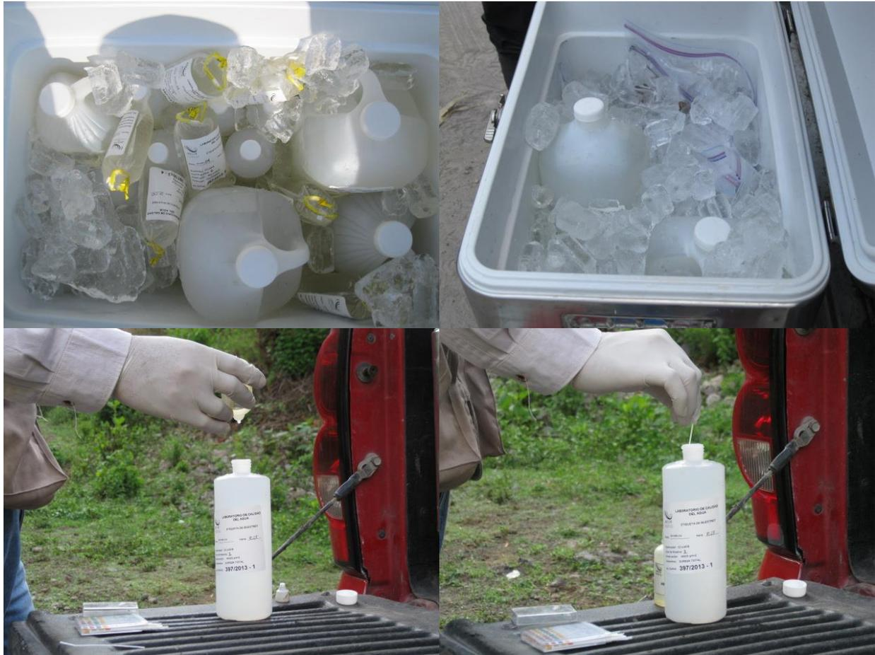
**Figura 4** Preservación de muestras de agua y sedimento
