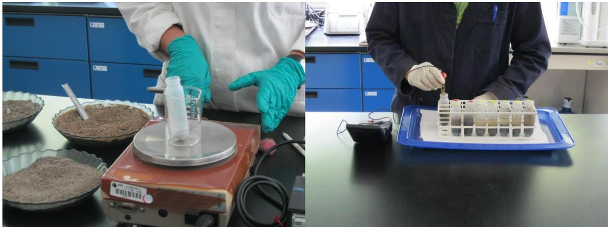
**Figura 8** Preparación de suspensión agua-sedimento y lectura de pH
