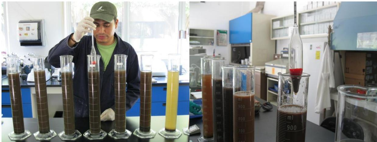
**Figura 10** Introducción de hidrómetro para granulometría mediante lectura de densidad
