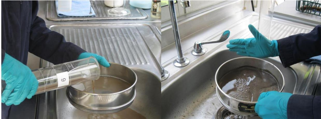
**Figura 11** Tamizado de muestra de sedimento con malla No. 200
