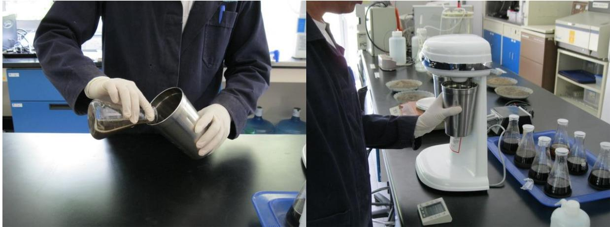
**Figura 9** Agitación de muestra de sedimento para determinación de granimetría
