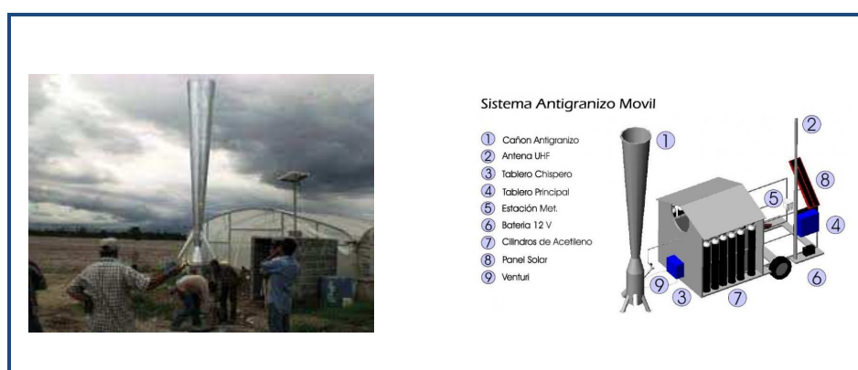
Figura 4. Esquema de un sistema antigranizo móvil.
