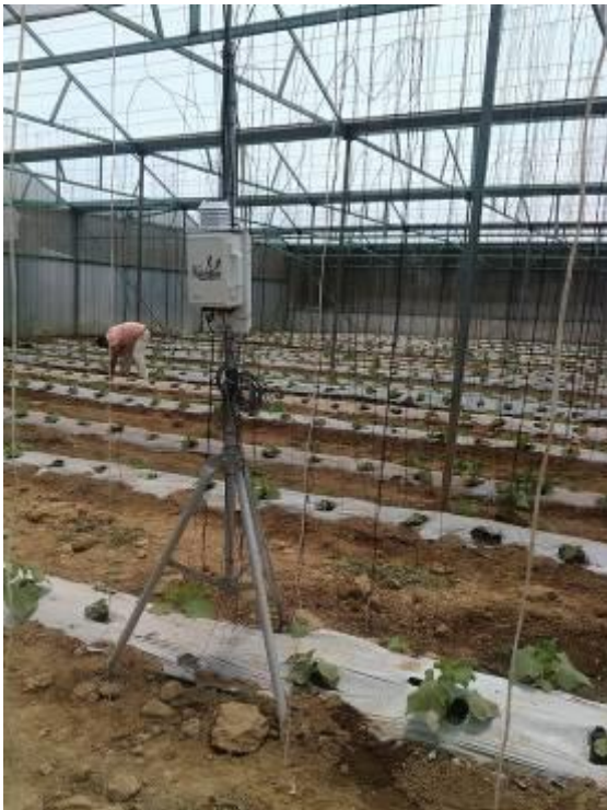
Imagen 1.7 Pepino recién sembrado directo bajo acolchado de plástico (edad 10 días) y estación meteorológica instalada dentro del invernadero (Imagen tomada 14 mayo 2012).
