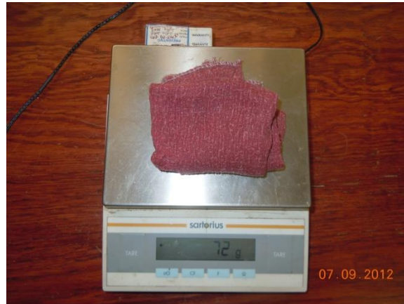
Figura 106. Obtención de la humedad del trapo.
