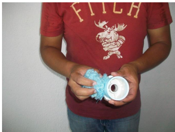
Figura 24. Limpieza del material de P.V.C.
