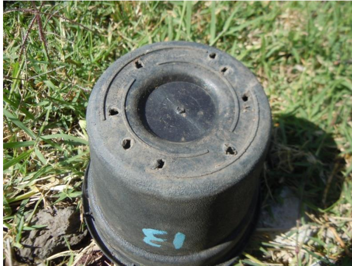
Figura 219. Orificios de drenaje.
