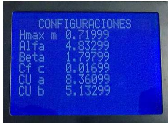
Una vez ya verificado los datos se teclaea la tecla gato en el teclado para comenzar la medición correspondiente, pero antes de comenzar la medición el micro controlador verifica que este insertada una memoria SD en la cual será guardada toda la información que este midiendo el sensor, incluyendo fecha y hora.
