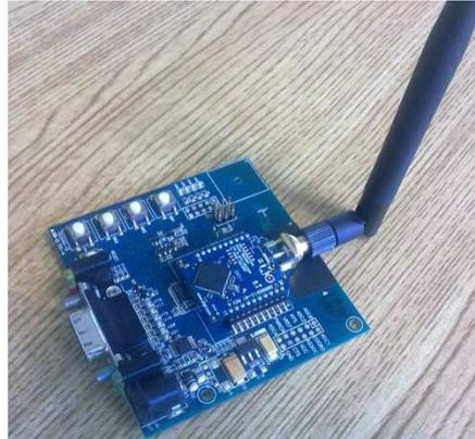
Radio Xbee armado, con su antena y su base adecuada para recibir información y envío de datos
