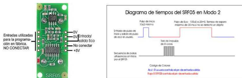
**Figura 0.1 Diagrama de tiempos del sensor SRF05, modo de operación de pin único**
