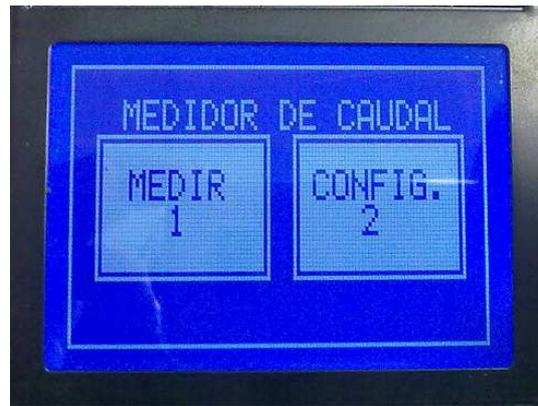
Se muestran dos menús en el cual en la opción de MEDIR 1, manda a pedir los datos que ya hayan sido ingresados en la opción de configuración si el medidor aun no tiene ningún datos simplemente pasara a otra ventana en la cual mostrara si ahí datos ingresados o no, en este caso seleccionaremos la opción de configuración 2 para ingresar los datos correspondientes para comenzar la medición.
