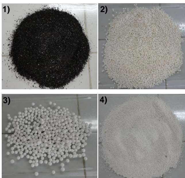
Figura 4-1 Medios adsorbentes 1) Carbón de hueso, 2) Alúmina actiguard, 3) Alúmina pseudoboehmita, 4) Dióxido de titanio
