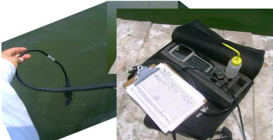
Figura 5.- Equipo multiparamétrico usado para las determinaciones de parámetros de campo en el agua de los sistemas lagunares.
