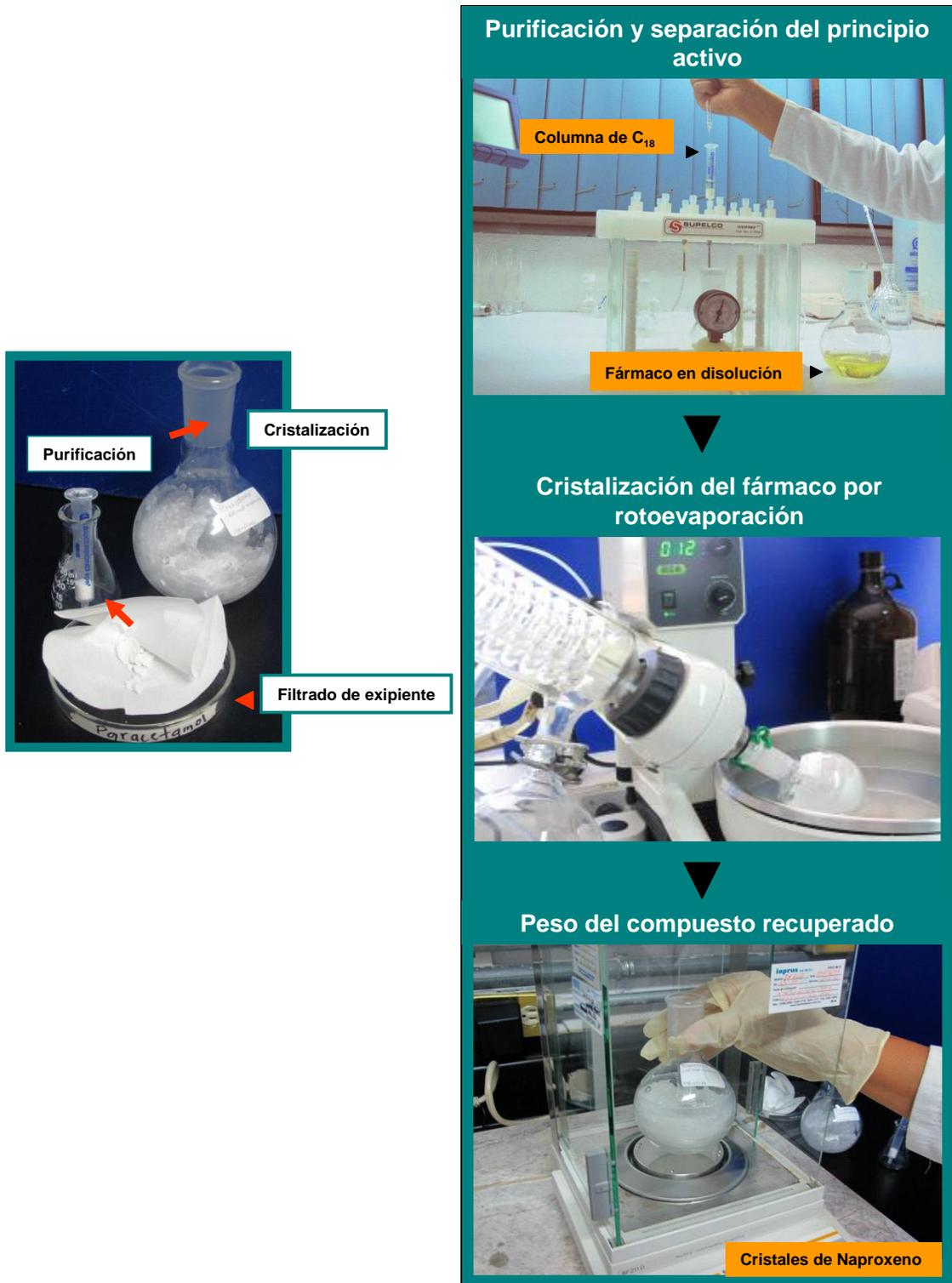
Figura. 5. Método para la purificación del principio activo a partir de fármacos comerciales
