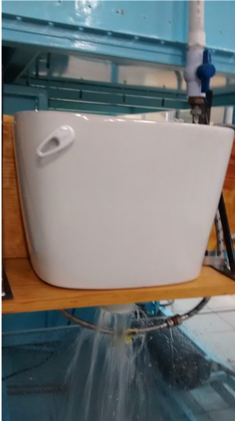
Foto 16. Acción del escudado para la determinación de la variación de caudal.
