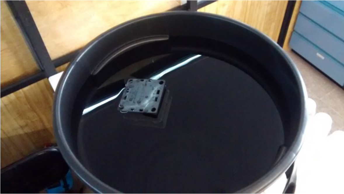
Ilustración 244. Dispositivo de Ión-Ag+, dentro del tanque de prueba.
