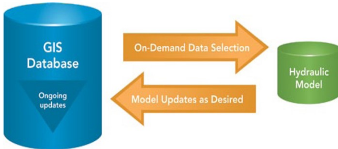
Ilustración 19. Integración de una base de datos y un modelo hidráulico. Los datos del SIG están fácilmente disponibles para el análisis de modelos y los datos del modelo se pueden migrar de nuevo al SIG como se desee para su uso en futuras ejecuciones de modelación.
