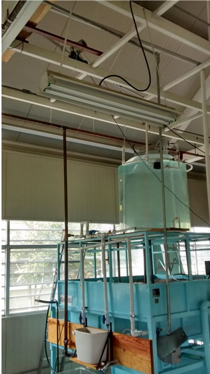
Foto 6. Instalación del Caudalímetro electromagnético antes del depósito.
