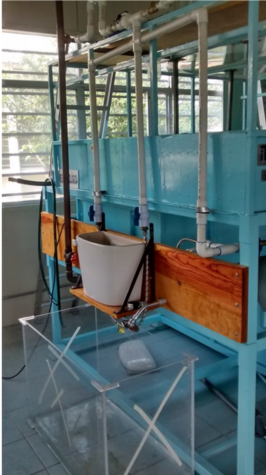
Foto 4. Depósito en acrílico para la medición del volumen
