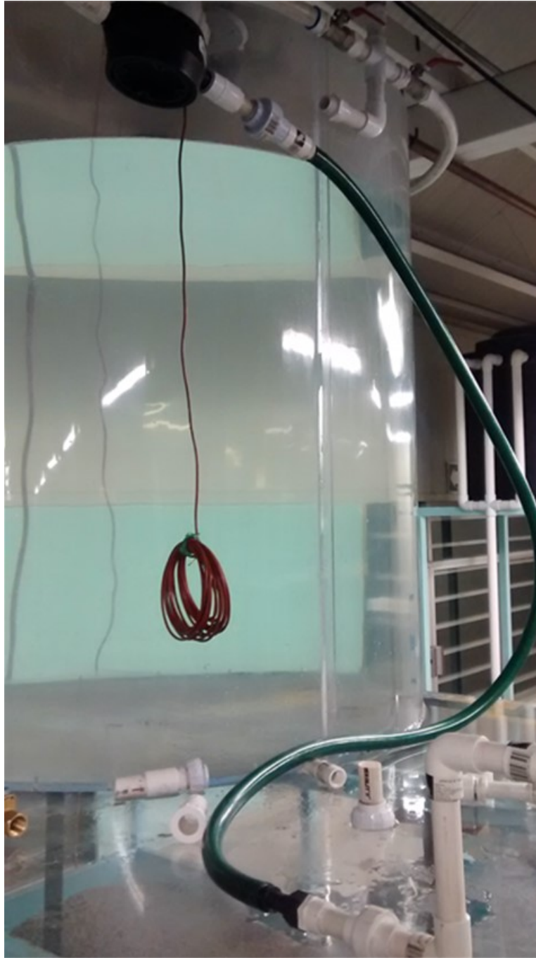
Foto 15. Instalación del caudalímetro y del micromedidor obviando el depósito, continuación.
