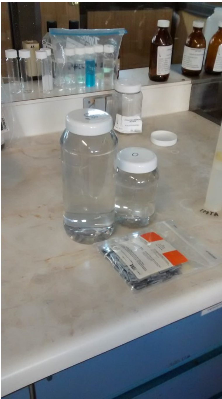
Ilustración 243. Toma de muestra para análisis de Ag por espectrofotometría de Absorción Atómica (continuación)
