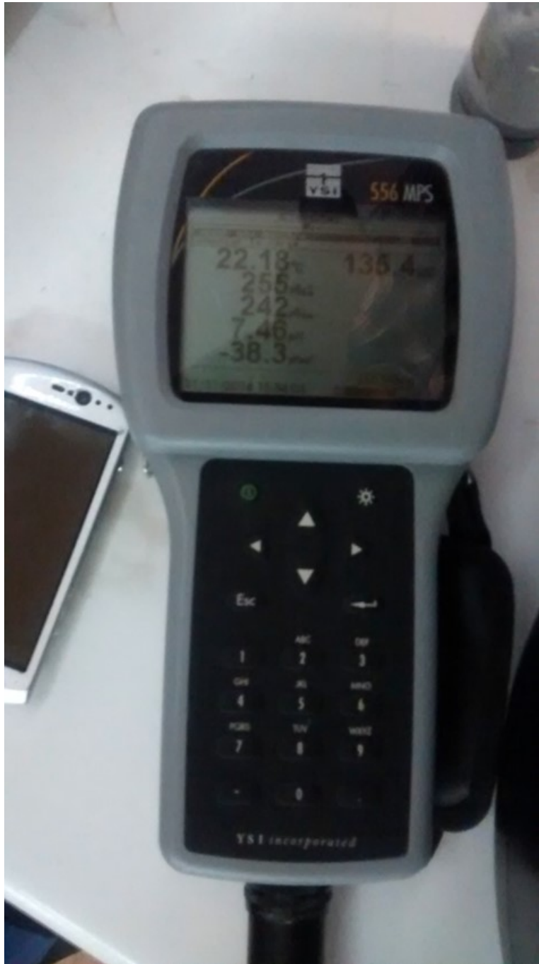
Ilustración 246. Obtención de las medidas de pH, Conductividad y ORP en el equipo multiparamétrico.
