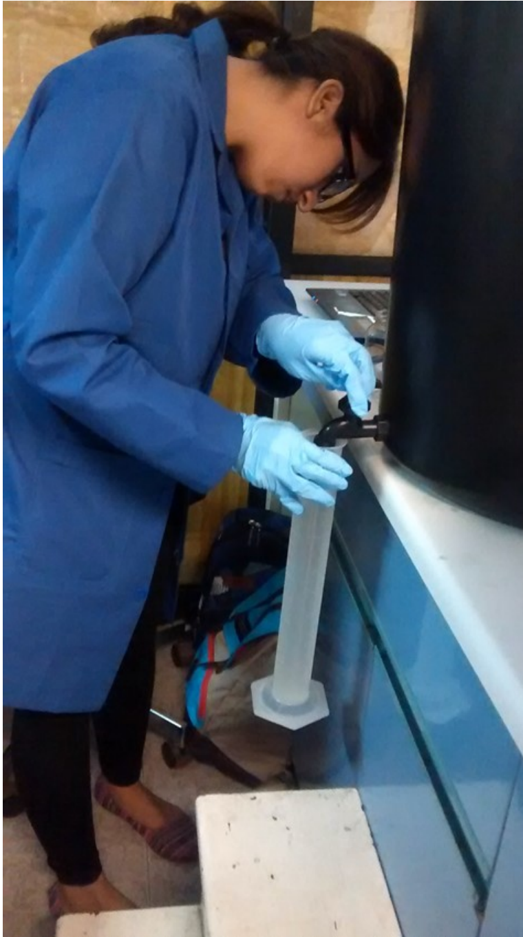
Ilustración 241. Toma de muestra para análisis de Ag por espectrofotometría de Absorción Atómica.
