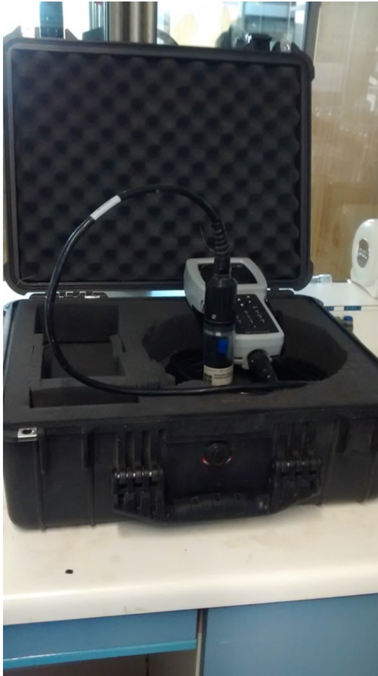
Ilustración 240. Equipo multiparamétrico YSI para la medición de parámetros de pH, conductividad y ORP.
