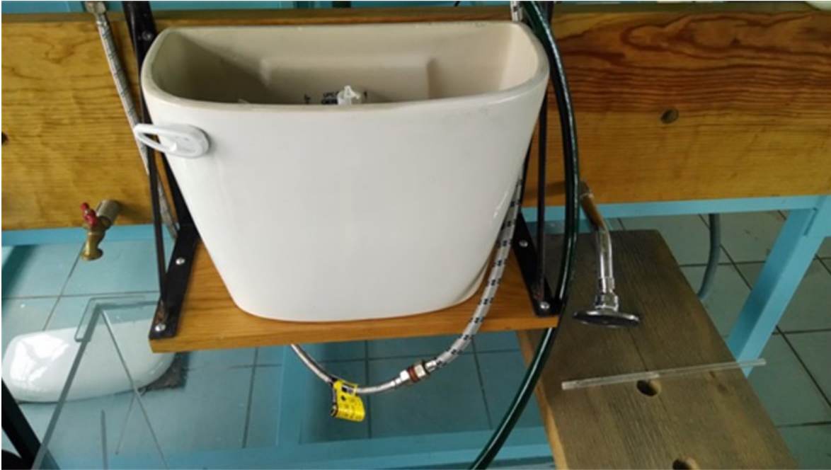
Foto 3. Accesorios para la medición de la variación de caudal
