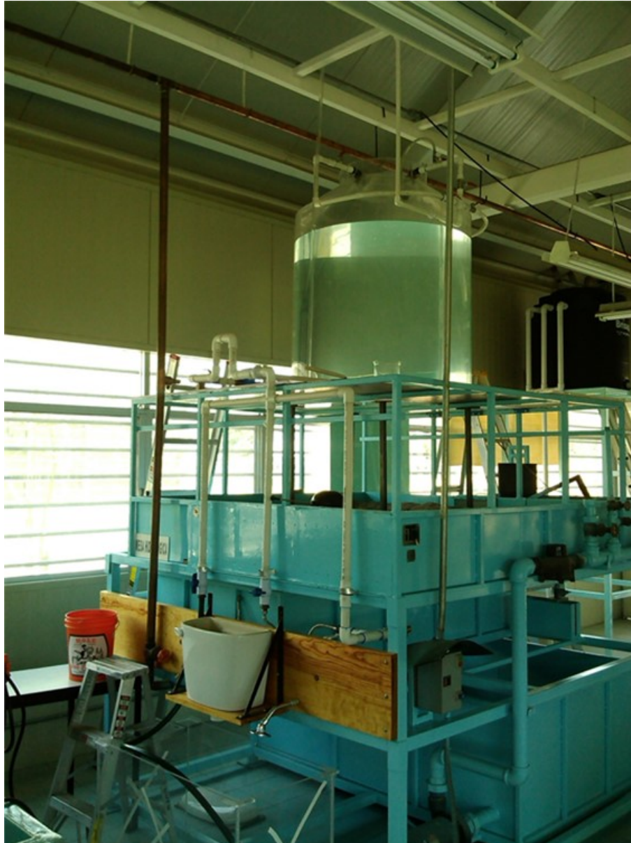
Foto 1. Sistema para las mediciones de la variación de caudal
