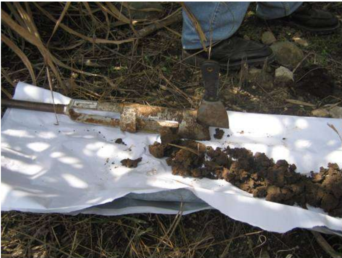
Figura 4-31. Muestreo de suelo mediante barrenación
