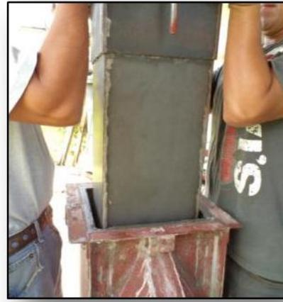
**Foto 17. Desmoldado del prototipo**
