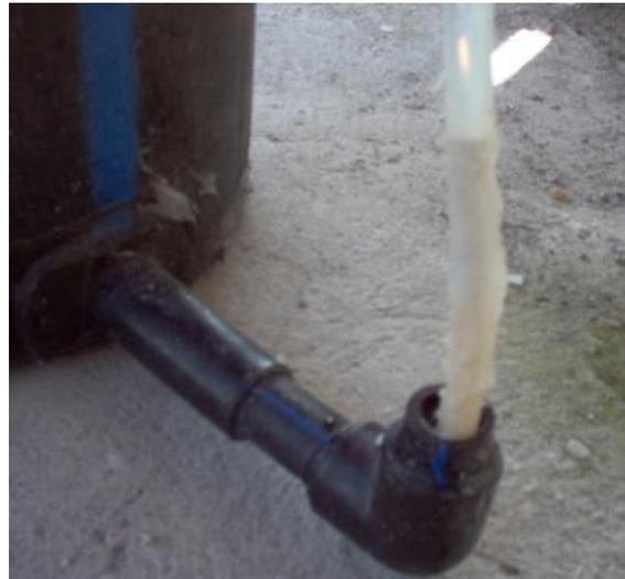
**Foto 30. Obstrucción con arena de la manguera de salida**
