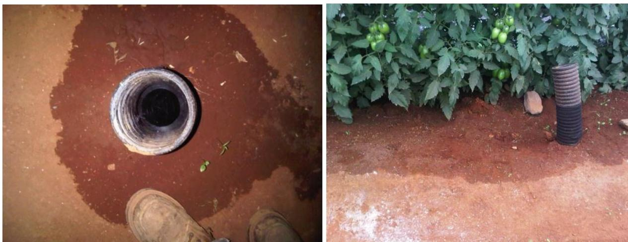
**Ilustración 61.** Pozo de observación y humedecimiento capilar
