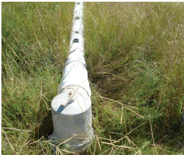
Foto 1.5 Toma parcelaria de baja presión con multicompuerta
