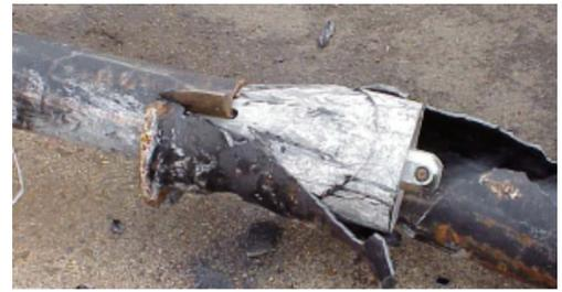
Figura 6.12 Cabezal de fracturamiento (topo)
