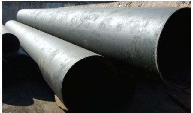
Foto 2.3 Tubería de acero al carbón
