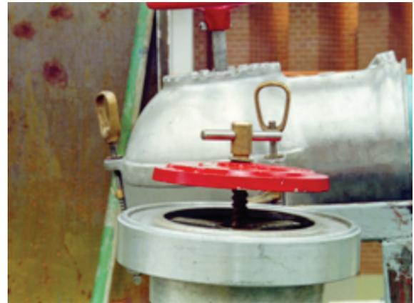
Foto 4.10 Dispositivo de aforo en hidrante
