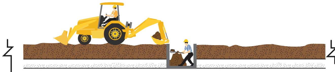
Figura 6.23 Desazolve manual en estructuras de regulación
