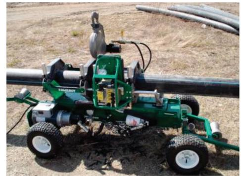
Foto 2.14 Equipo de termofusión
