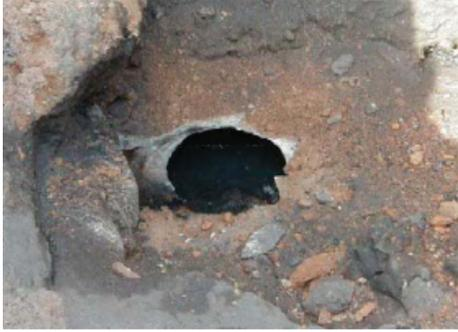
a) Tubería fracturada
