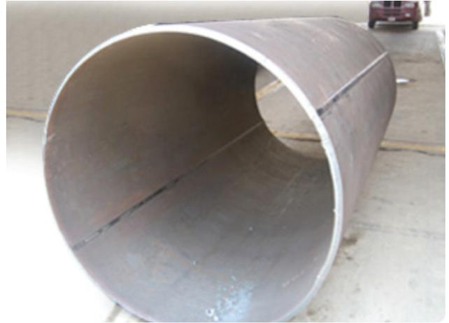
Foto 2.2 Costura de la tubería de acero
