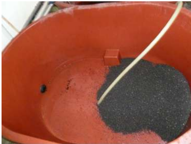
Foto 5.8 Lavado de material filtrante
