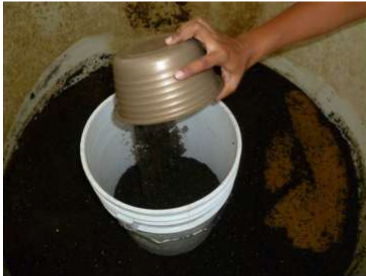
Foto 5.7 Retiro de la primera capa de material filtrante
