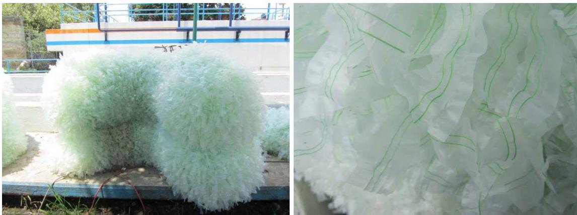
**Figura 2.9. Cinta de polietileno de baja densidad.**
