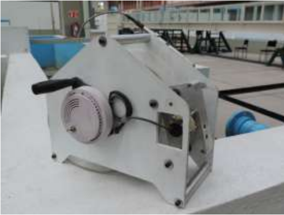
MetroSonda con sensores de nivel de agua y fondo modificados
