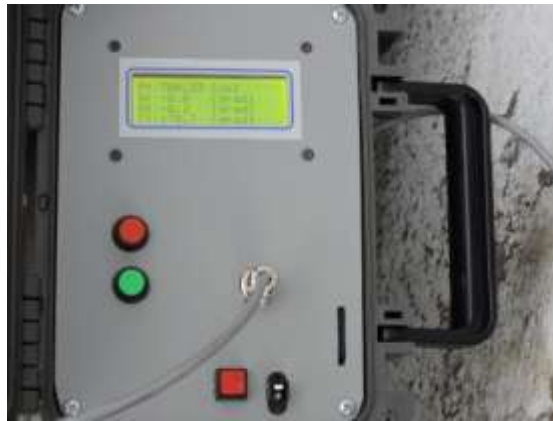
Registro de los sensores de inclinación
