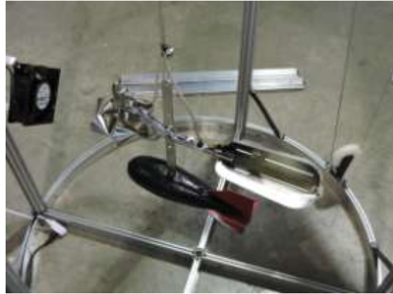
Sistema suspendido molinete - escandallo
