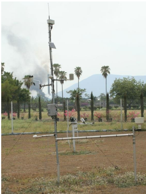
Foto 1. Instalación de sensores, recomendación de OMM.
