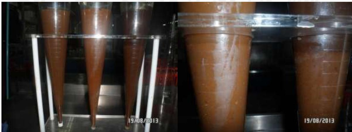
Figura 4.5. Pruebas de sedimentación en conos Imhoff
