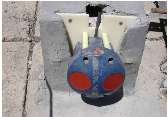
MEDIDOR DE VELOCIDAD ACÚSTICO DE EFECTO DOPPLER (FRECUENCIA DE 3 MHz)
