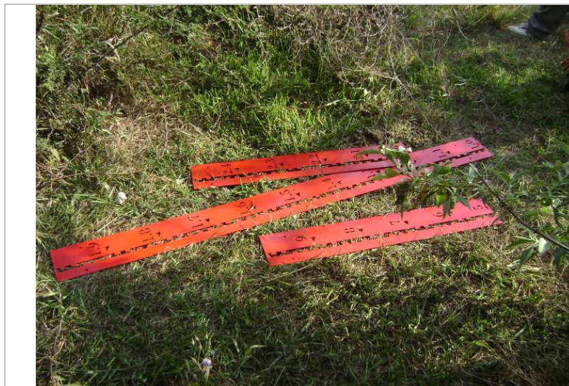
ESCALAS METÁLICAS LISTAS PARA SU COLOCACIÓN
