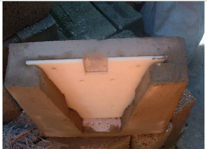
BASE DE CONCRETO Y PLACA DE NYLACERO
