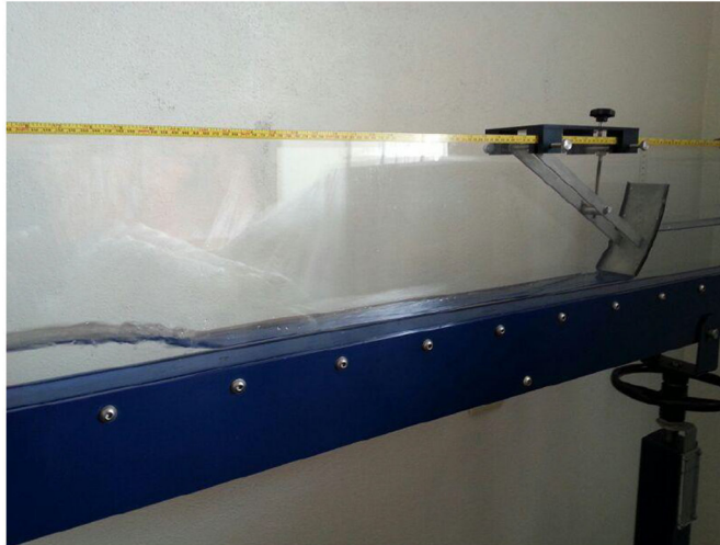
Figura 17. Imagen de las prácticas de laboratorio en el canal tipo Armfield para los perfiles de flujo Fuente: “Solución de la ecuación dinámica usando el canal Armfield en el laboratorio de Hidráulica” (Yescas, 2014). Universidad Autónoma Chapingo
