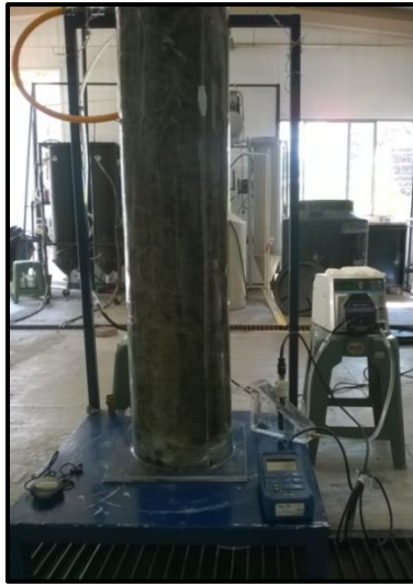
Figura 3.6 Material y equipo empleado para la prueba cinética en el lecho del reactor 2
