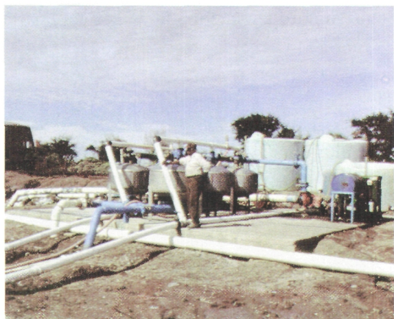
Lámina 1a. Cabezal de control de un sistema de inyección de fertilizantes.
