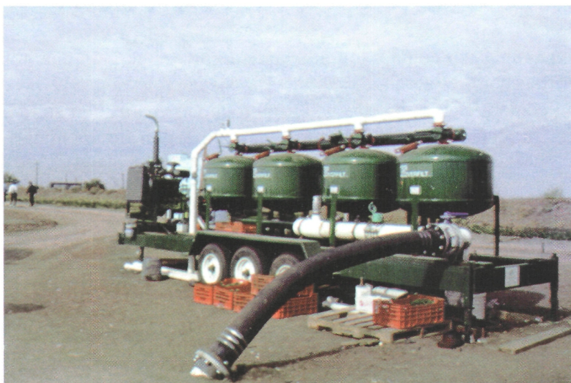
Lámina 19. Cabezal de control con inyección central
