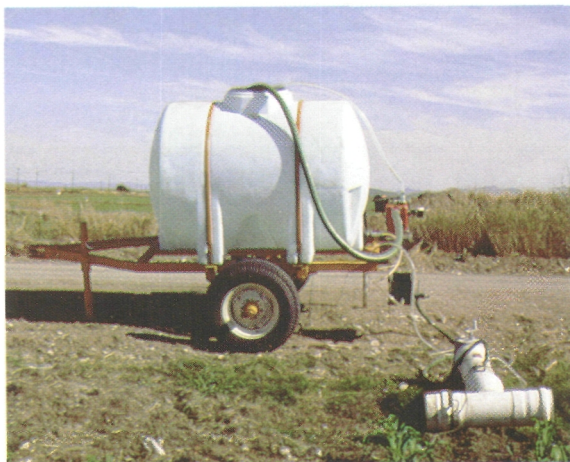
Lámina. 14a. Inyector de fertilizante, para tuberías con compuertas en riego por gravedad.
