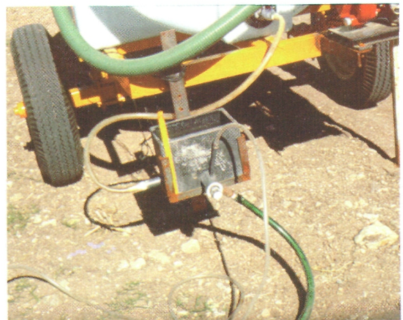
Lámina.14b. Acercamiento al inyector de carga constante con flotador.
