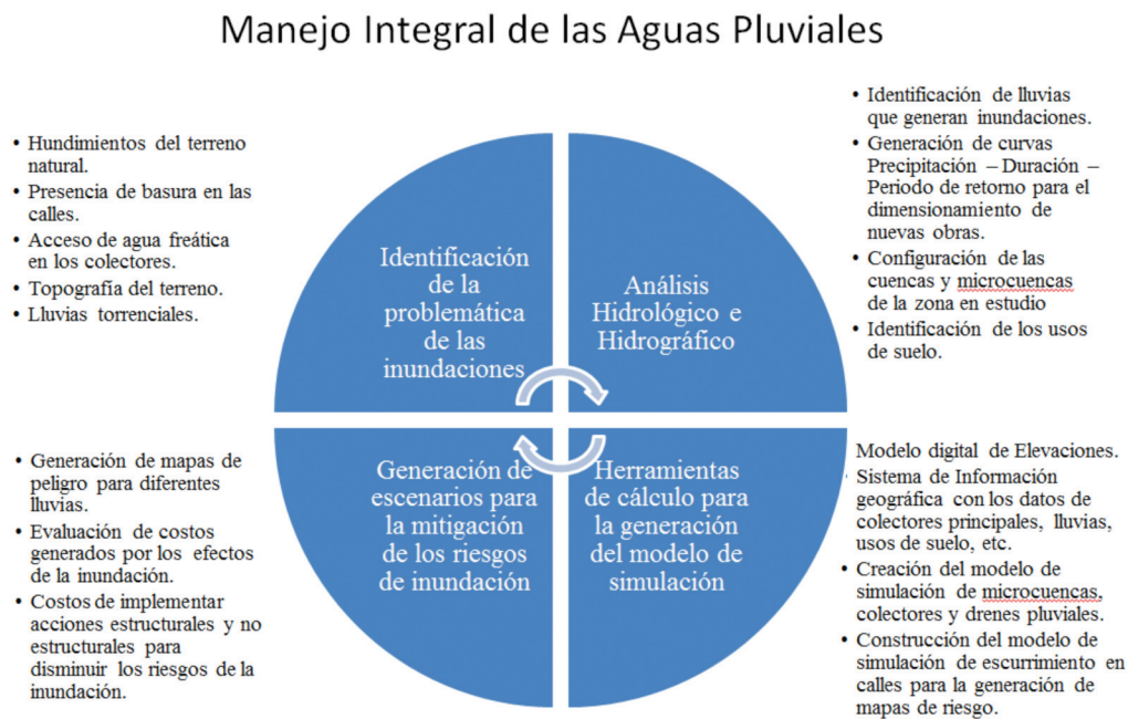
Ilustración 1. Componentes de un programa para el manejo integral de las aguas pluviales (Alcocer et al. 2012).
