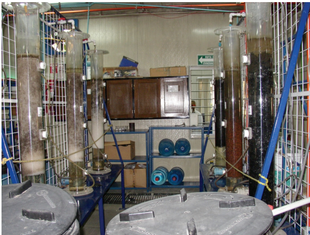
Ilustración 1. Biofiltros experimentales con diferentes materiales de soporte de la biomasa.
