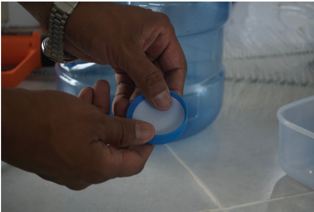
a) Colocación de liner.
