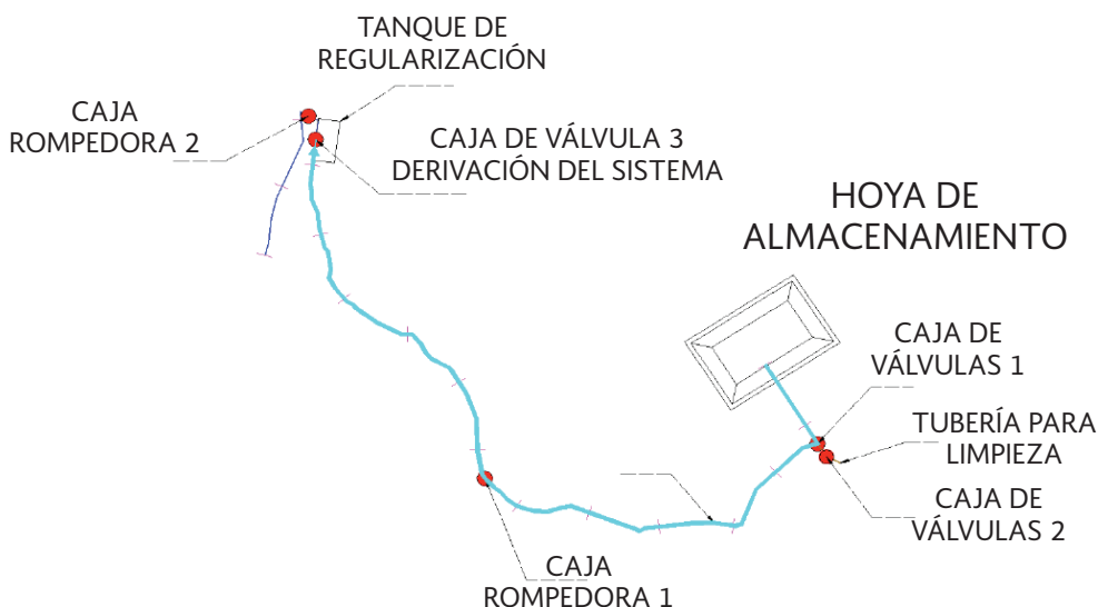
Figura 27. Servicio al tanque de regularización
