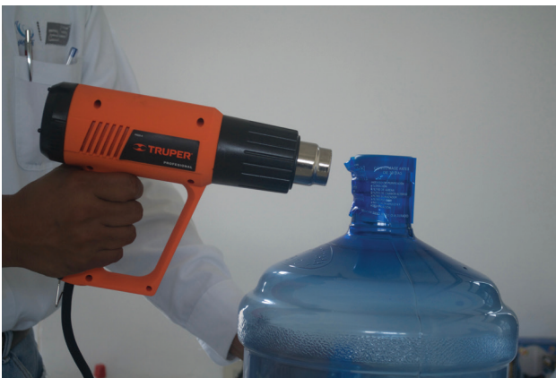
c) Colocación del sello de garantía con una pistola de calor.
