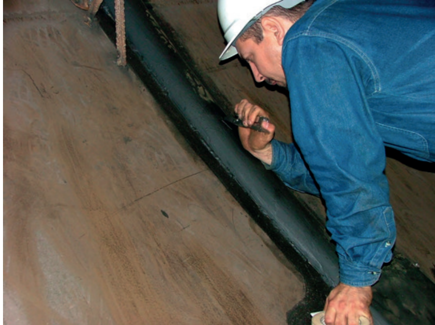
Figura 2.45 Prueba de adherencia. Rayado de la superficie a probar.
