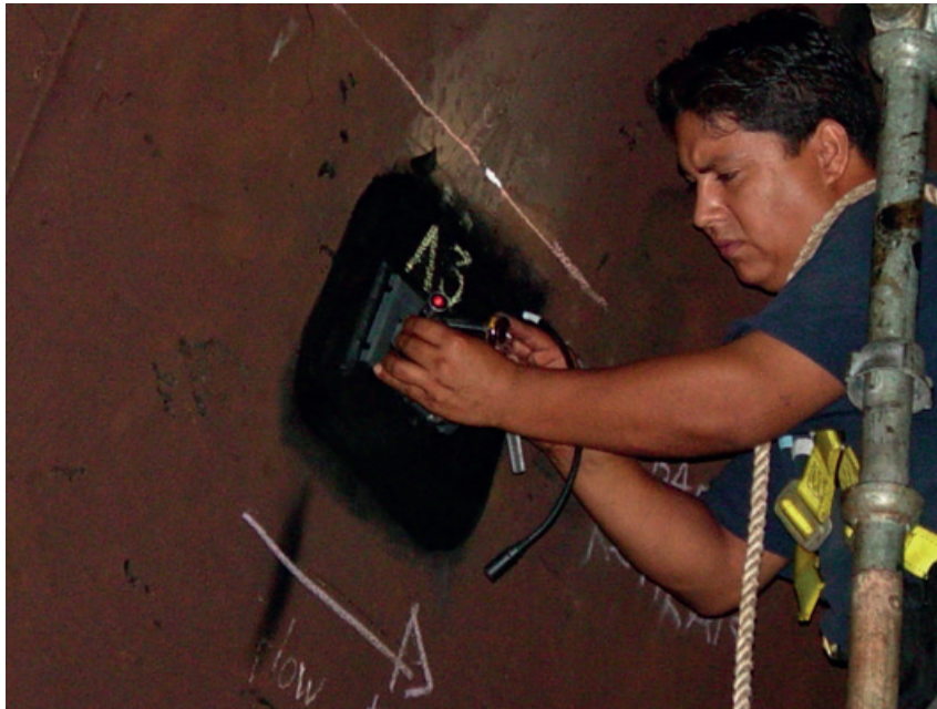
Figura 2.49 Ajuste de la alineación del Sensor.
