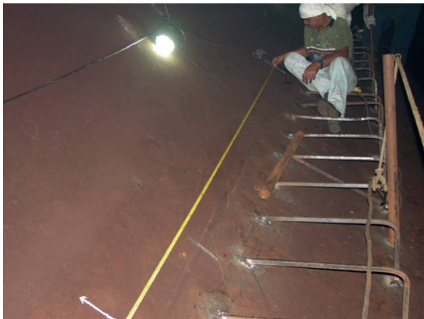
Figura 2.18 Del Centro del sistema se mide una la mitad del diámetro hacia aguas arriba y hacia aguas abajo para ubicar el sitio de colocación de los sensores.
