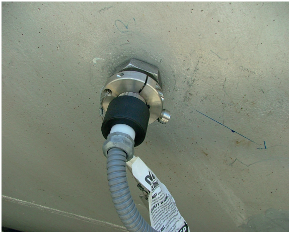
Figura 3.47 Vista de los sensores de inserción.
