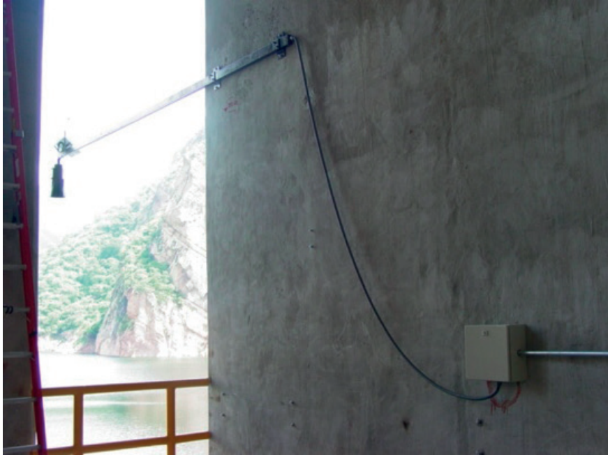
Figura 2.71 Sensor de nivel tipo ultrasónico para determinar la elevación del espejo de agua del embalse.
