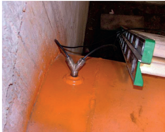
Figura 3.40 Salida del cable de los sensores por el conector.
