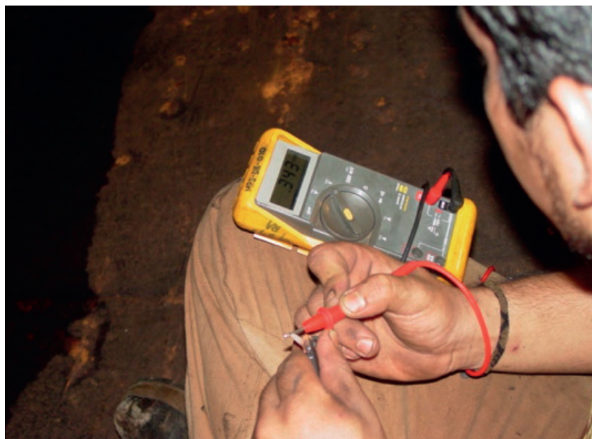
Figura 2.58 Lectura del voltaje generado por la señal.
