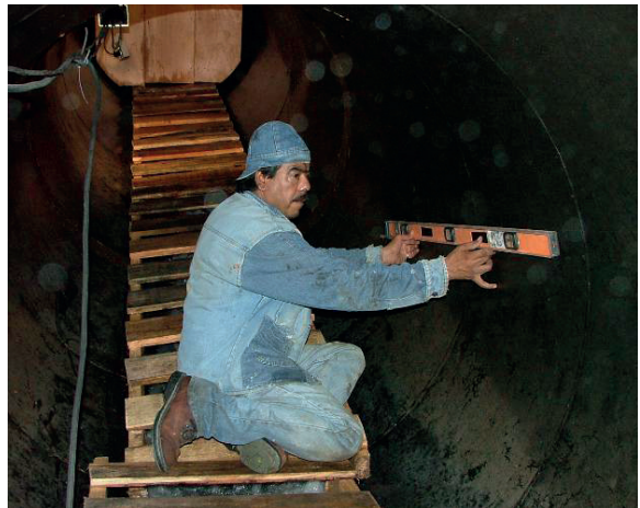
Figura 3.32 Mediciones preliminares para ubicación de sensores.
