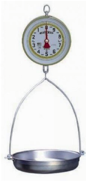
Figura 4.6 Un dinamómetro puede requerir un factor de corrección.
