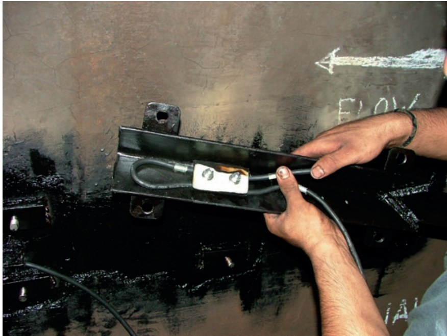
Figura 2.56 Vista externa de la conexión de sensor-cable de señal.
