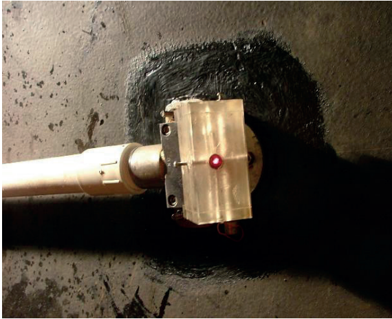
Figura 3.37 Alineamiento de sensores con rayo láser.
