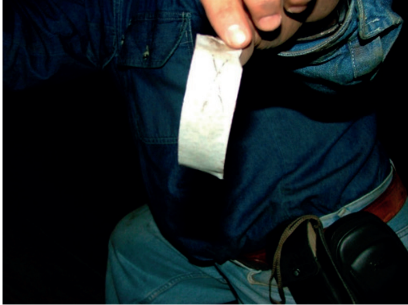
Figura 2.47 Resultados de la prueba de adherencia. En este caso, se concluye que la limpieza mecánica y química, el rayado del metal base, la aplicación del producto y tiempo de secado, fueron adecuados.
