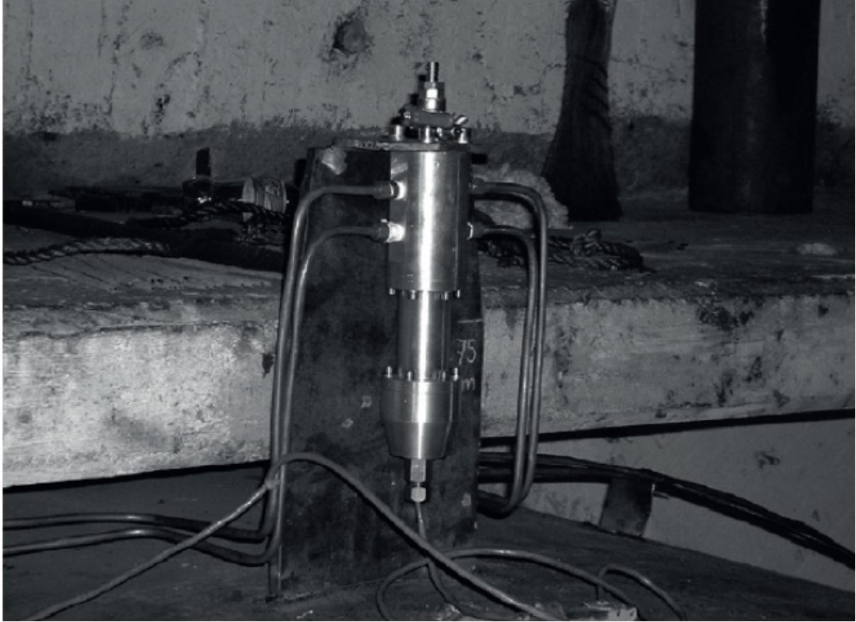
Figura 2.10 Colector que recibe la presión de 4 tomas. Instrumentación del método de Gibson. Urquiza, G. et al. (2007).
