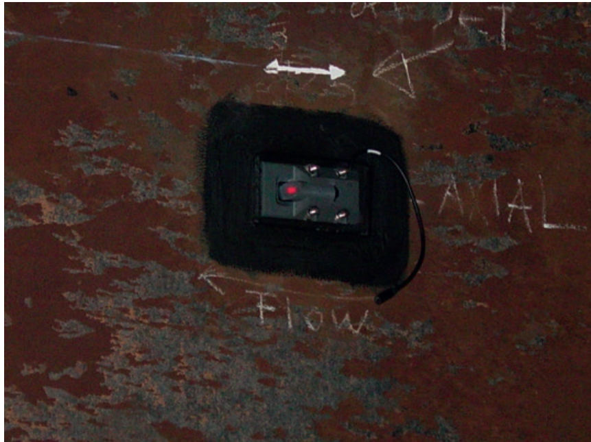
Figura 2.50 Incidencia de rayo láser sobre la cara opuesta de un sensor respecto de otro desde el cual se está verificando la alineación.
