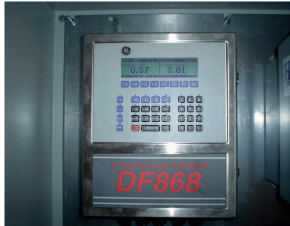
Figura 3.22 Unidad electrónica del medidor.
