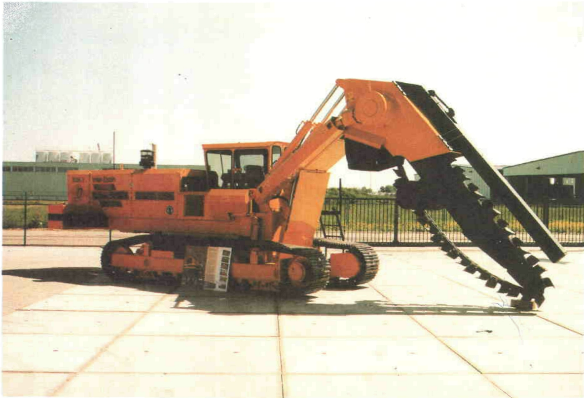
Foto 8. Zanjadora de cadena
