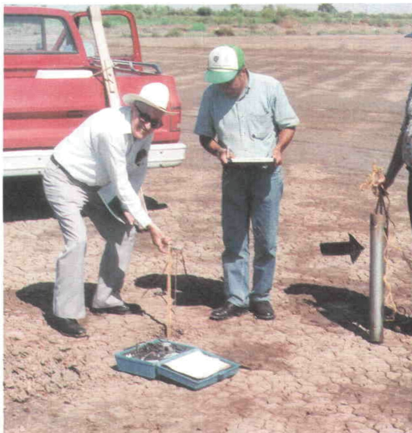
Foto 3. Recipiente cilíndrico para extraer el agua del pozo (ver flecha)
