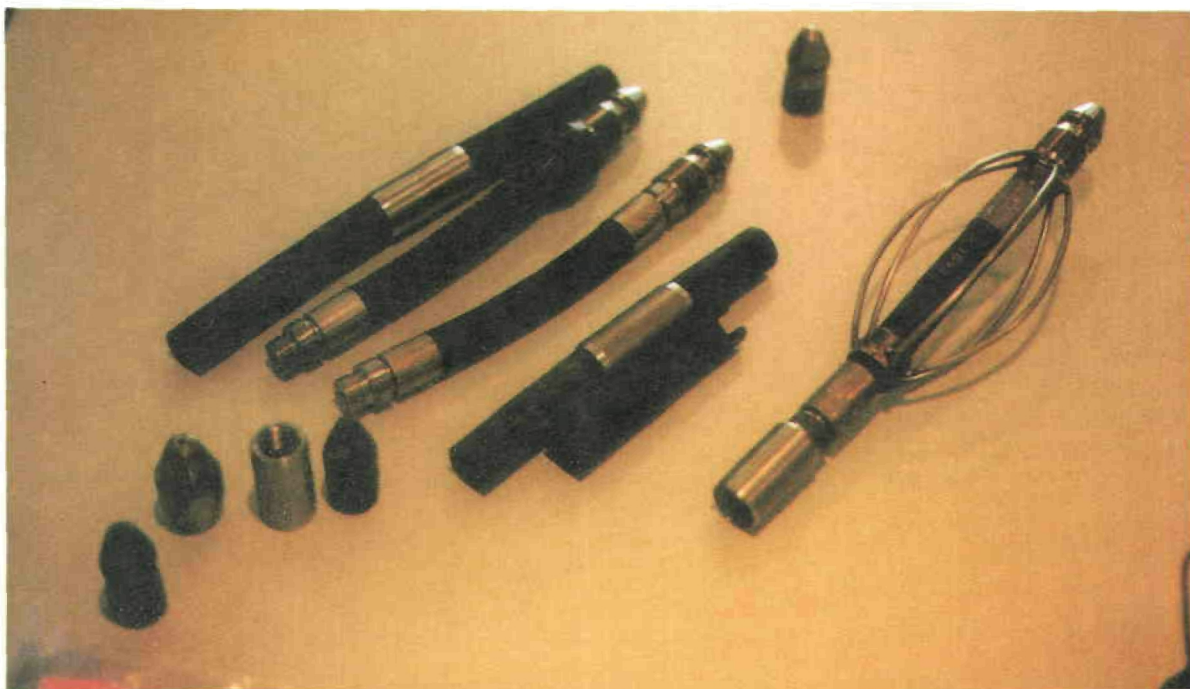
Foto 33. Boquillas para inyectar agua a presión
