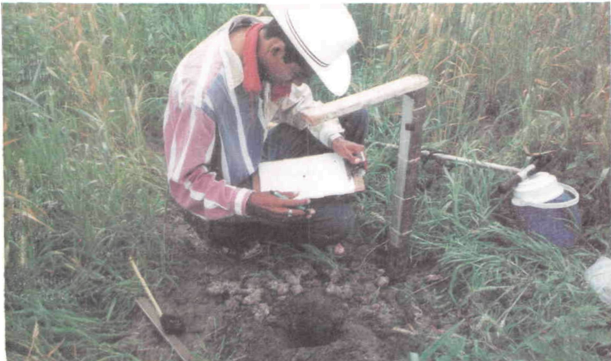
Foto 2. Determinación de la conductividad hidráulica por el método del pozo de barrena
