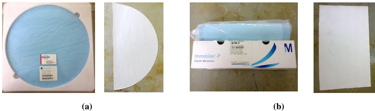
Figura 4.3. Membranas Millipore de 0.45 \mu\text{m} de PTFE (a) y PVDF (b).
