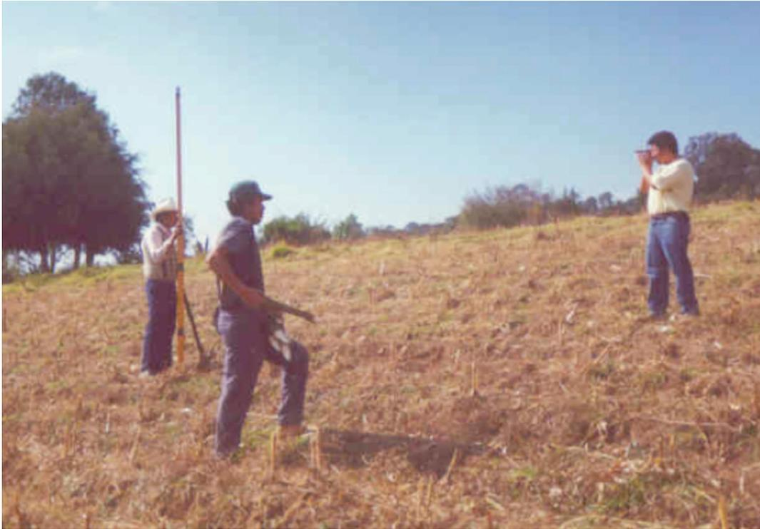
Fotografía 6. Marcando curva de nivel en Punto Clave con nivel de mano.
