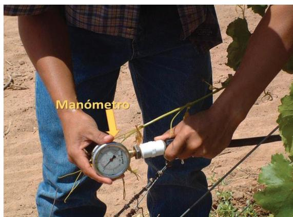
**Ilustración 37. Verificación de presión al final de sección.**
