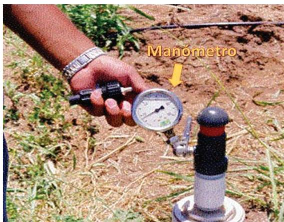
**Ilustración 36. Verificación de presión al inicio de sección.**
