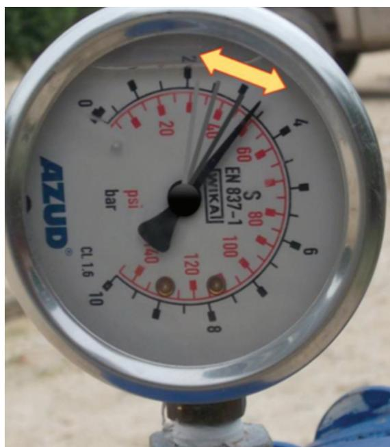
**Ilustración 23. Operación inestable de manómetro.**
