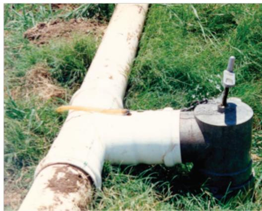
**Ilustración 3. Codo de arranque.**
