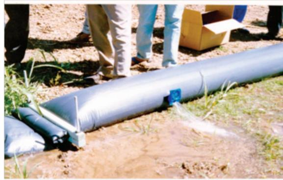
**Ilustración 5. Tubería multicompuertas de PEBD.**
