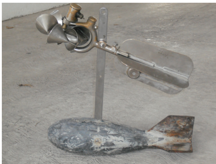
Figura 40. Molinete, timón y escandallo (torpedo) de 5 kg de lastre.
