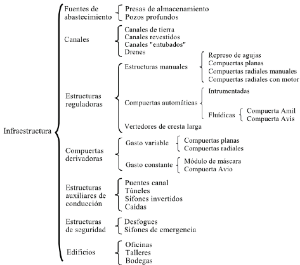
Figura 64. Esquema de la infraestructura para la administración y manejo del agua en canales de riego.
