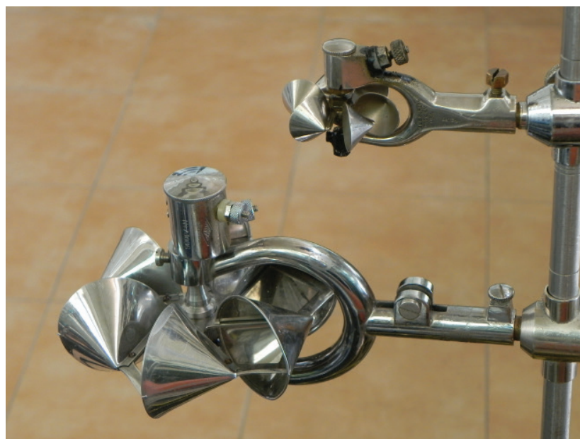
Figura 27. Molinetes de copas, modelos estándar (inferior) y pigmeo (superior).
