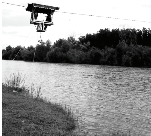
Figura 37. Aforo en la estación hidrométrica cable-canastilla, en Agustín Melgar, sobre el río Nazas, Dgo.
