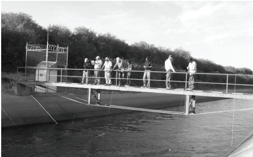
Figura 36. Aforos en la salida de la presa Josefa Ortiz de Domínguez, en ocasión de un experimento de comparación entre aforos con molinete y con técnicas de ultrasónico (2007). Estación tipo puente rígido de metal.
