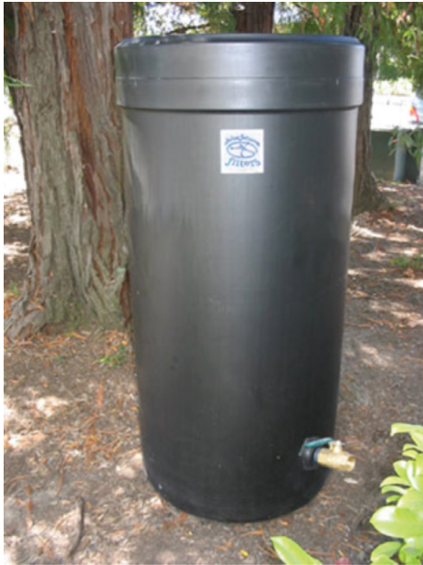
Figura 4-5: Filtro grueso de flujo ascendente de una etapa en un tanque prefabricado, modelo “RF/x” para 2 galones por minuto de caudal, de la empresa estadounidense Blue Future Filters.
