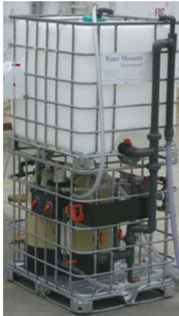
Figura 4-15: Sistema LivingWater utilizado por la ONG Misiones de Agua Internacional con capacidad de hasta 10 galones por minuto. Utiliza un filtro rápido a presión, bombas eléctricas, y cloro en tabletas. Necesita paneles fotovoltaicos donde no hay energía eléctrica.
