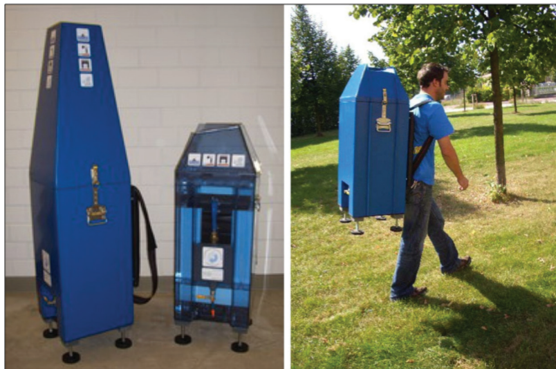
Figura 4-20: Mircofiltro de “mochila” para desastres diseñado en la Universidad de Kassel, Alemania (Frechen et. al., 2011)
