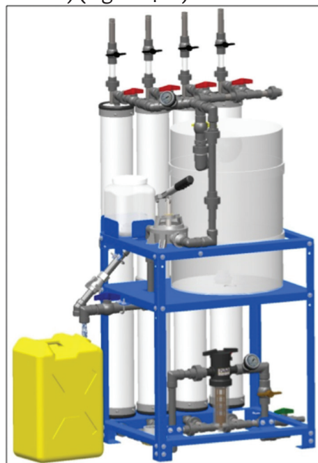
Figura 4-21: Sistema “GravityPure” de la ONG Healing Waters International. Los cilindros verticales al fondo representan cuatro unidades de membranas de ultrafiltración. La palanca con el mango negro es la bomba manual para efectuar el retrolavado. La configuración mostrada es para un punto de agua (Healing Waters, 2012).
