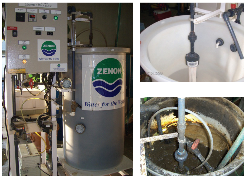
Figura 1. Biorreactor con membranas sumergidas a nivel planta piloto
