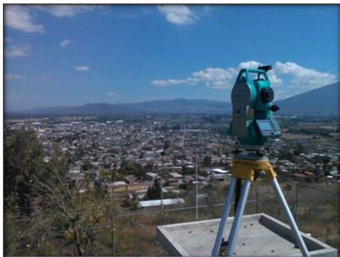
Estación total colocada en el tanque tanque
